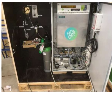
Figur 30: Mobilt NO x måler set-up og Eco Physics CLD 60 anvendes til in-situ målinger
