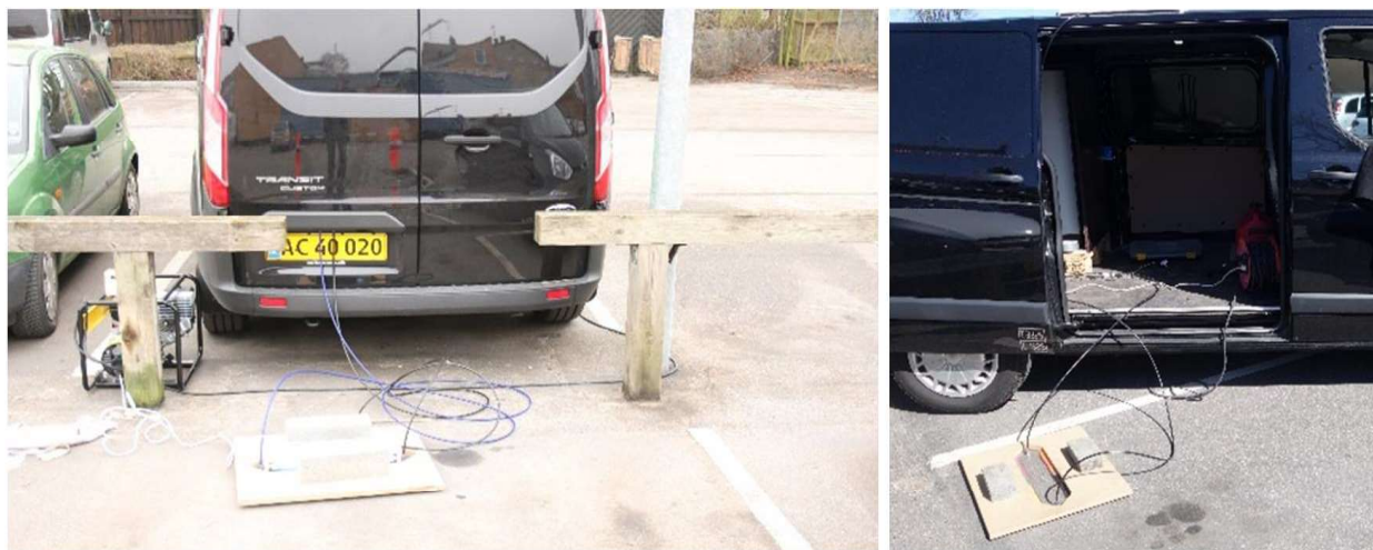
Figur 32: In-situ målinger med NO x set-up'et integreret i varebil
