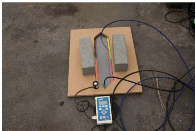
Figur 35: Eksempel på måling af lysintensitet
